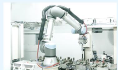
クリニカルバイオリソースの収集ロボットシステム「BRAHMS」。生体試料を高品質な状態のまま、採取・処理・保管する。
