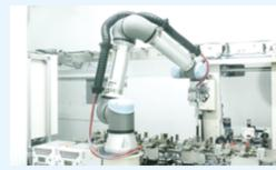
クリニカルバイオリソースの収集ロボットシステム「BRAHMS」。生体試料を高品質な状態のまま、採取・処理・保管する。
